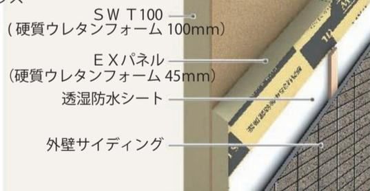
外壁 (サイディング) の内側には約15cmの断熱材を使用。外気温の影響を受けにくい高断熱仕様。
